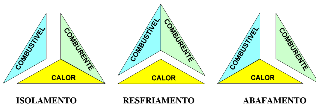
Figura 2.8 . Métodos de extinção do fogo. Fonte: Araújo (2002)
